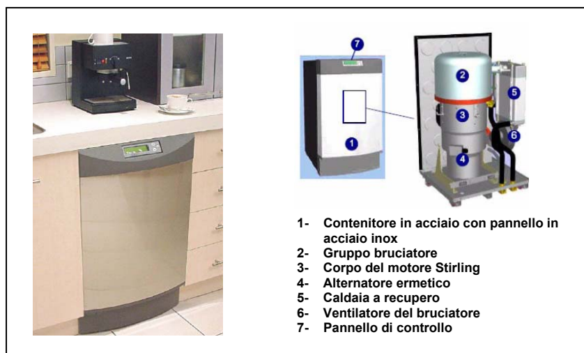
Fig. 17 – Immagine e schema costruttivo di unità cogenerativa a ciclo Stirling per uso domestico da 1.2 kW e (Fonte: Whispertech).
